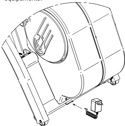
2 - Conecte primeiramente o plugue do carregador de bateria na tomada elétrica e, em seguida, conecte a extremidade do cabo do carregador no conector do Power Cross, localizado na parte inferior frontal do equipamento (figura ao lado).
