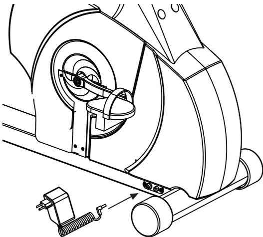
2 - Conecte primeiramente o plugue do carregador de bateria na tomada elétrica e, em seguida, conecte a extremidade do cabo do carregador no conector da bicicleta, localizado na lateral direita do equipamento (figura ao lado).
