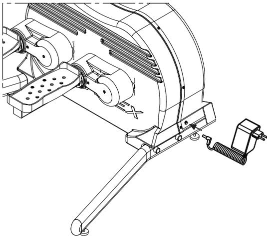
2 - Conecte primeiramente o plugue do carregador de bateria na tomada elétrica e, em seguida, conecte a extremidade do cabo do carregador no conector do circle fit, localizado na lateral direita do equipamento (figura ao lado).
